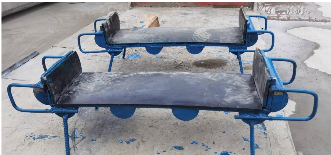
预制 T 梁提梁工装实图
