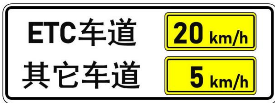
图 8.2.2 车道类型及建议速度标志样例
