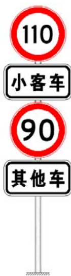
图 B.1.2-1 柱式分车型限速标志版面示例
